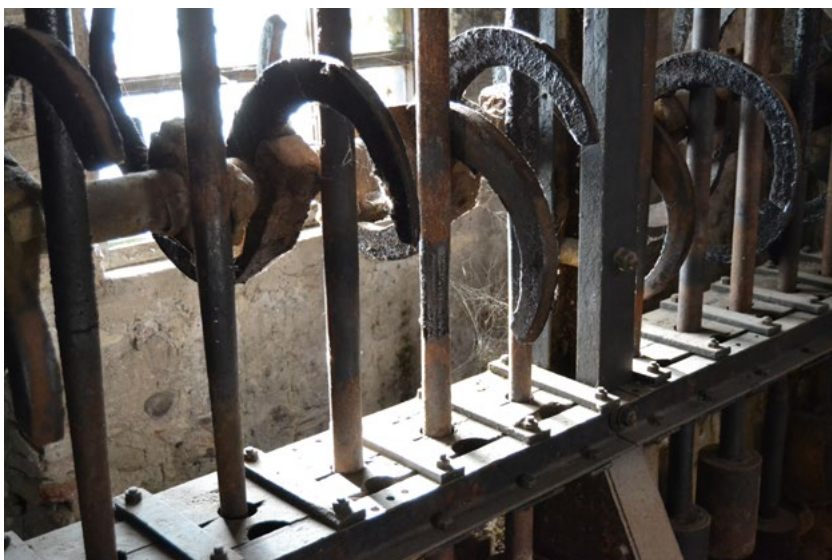
Fig. 13 – Mulino di Nove. Particolare dell'albero a camme.
