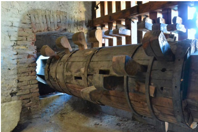
Fig. 21 – Mulino di Nove. Particolare dell'albero della ruota sud con le palmole destinate a sollevare i pestelli.
