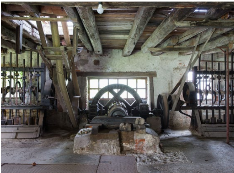
Fig. 15 – Mulino di Nove. Il lubecchio e le due lanterne che trasmettono il movimento ai pestelli tramite cinghie di cuoio.
