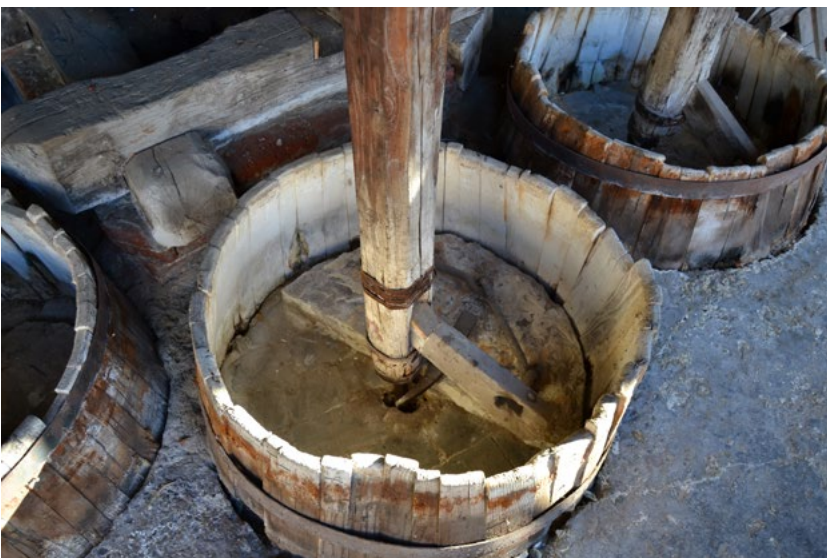
Fig. 26 – Mulino di Nove. Impianto sud ripreso dall'alto per evidenziare le macine a semiluna all'interno dei tini.
