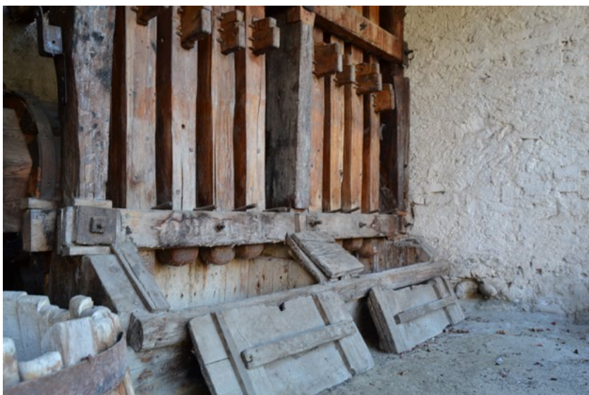
Fig. 22 – Mulino di Nove. La parte inferiore dei pestelli lignei con le teste in ferro all'interno delle tramogge.
