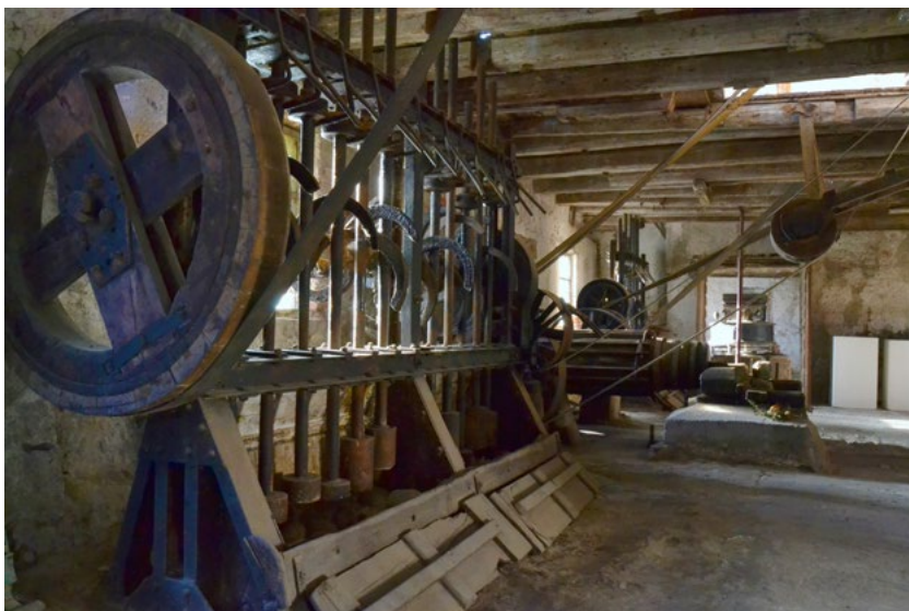
Fig. 12 – Mulino di Nove. Batteria di pestelli, in acciaio, per la frantumazione dei minerali.
