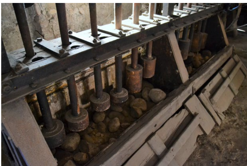
Fig. 14 – Mulino di Nove. Le “teste” dei pestelli e i ciottoli all’interno delle tramogge.
