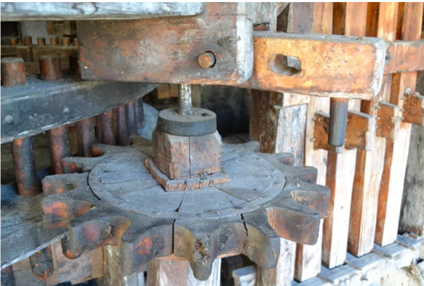
Fig. 25 – Mulino di Nove. Particolare di uno dei satelliti con il braccio che ne consente l'estrazione per la posizione di riposo.
